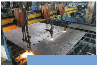
Раскрой листового металла – Термическая газовая резка
